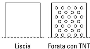
Doga autoportante adatta ad ambienti con ampia luce che consentono la realizzazione di controsoffitti privi di fughe. Adatta al montaggio in corridoio e in ambienti di piccole dimensioni. È possibile abbinarla ad un rompitratte.
