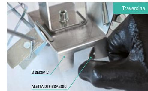
Aprire le alette presenti sui lati del kit antisismico. Per facilitare il movimento aiutarsi con un cacciavite e fare leva in modo tale da agevolare l'apertura.
