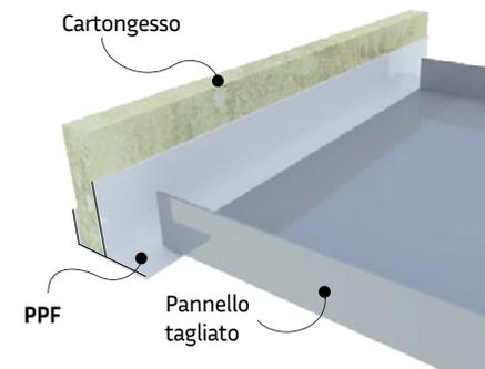
Il profilo PPF viene utilizzato maggiormente per i raccordi tra il controsoffitto piano orizzontale ed un pannello di cartongesso, evitando la stuccatura del giunto.
