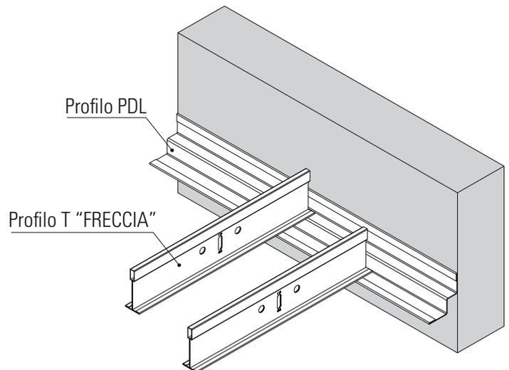
Il **PDL** oltre a svolgere la funzione di profilo perimetrale, ha come caratteristica la possibilità di creare scuretti data la sua forma scalettata e grazie a quest'ultima inoltre è possibile posizionare il profilo T sulla parte superiore o inferiore di esso. La colorazione del profilo PDL può variare a seconda della struttura T oppure dei pannelli scelti che saranno montati sul controsoffitto.
