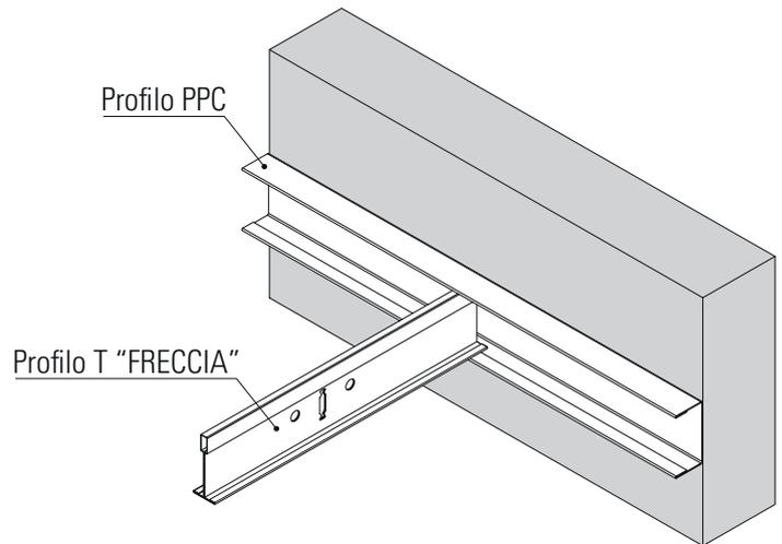
Il **PPC** oltre a svolgere la funzione di profilo perimetrale, ha come caratteristica la possibilità di rendere complanare un pannello metallico tagliato, utilizzando all'interno un profilo a C favorendone la rigidità e il bloccaggio dello stesso. La colorazione del profilo PPC può variare a seconda della struttura T oppure dei pannelli scelti che saranno montati sul controsoffitto.
