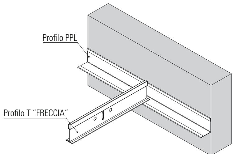
Il **PPL** è un classico profilo perimetrale a L con base a vista di 24mm. La colorazione del profilo PPL può variare a seconda della struttura T oppure dei pannelli scelti che saranno montati sul controsoffitto.
