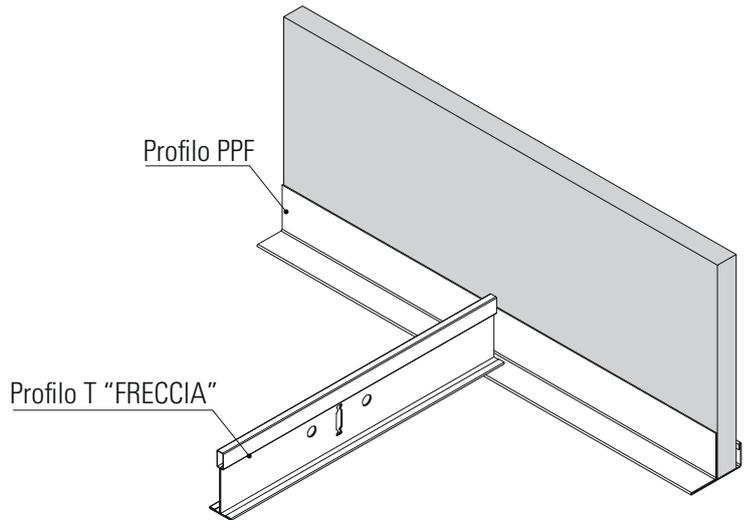
Il **PPF** oltre a svolgere la funzione di profilo perimetrale, ha come caratteristica quella di fungere da profilo di raccordo per i salti di quota (es. velette) evitando così processi di stuccatura ulteriori. E' possibile l'inserimento di pannelli in cartongesso da 13 e 15 mm. La colorazione del profilo PPF può variare a seconda della struttura T oppure dei pannelli scelti che saranno montati sul controsoffitto.
