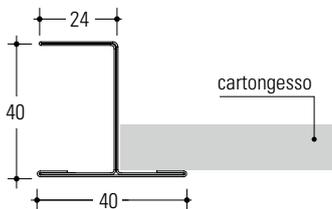
Profilo di raccordo "PR.PPU" per compenso orizzontale e controsoffitto, idoneo per montaggio con sistema tipo Vert Flat. Il profilo consente una perfetta integrazione con pannello tagliato o intero. Nella rappresentazione adiacente viene mostrata l'applicazione del profilo "PR.PPU" ed il pannello Vert Flat in appoggio. In caso di pannello tagliato viene aggiunto un profilo a "C" di bloccaggio per garantire la complanarità.
