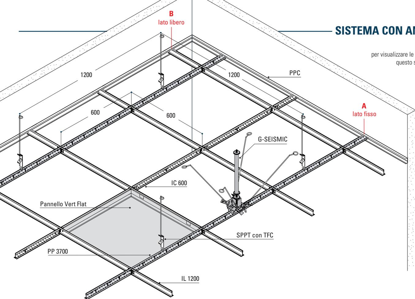
Il **PPC** oltre a svolgere la funzione di profilo perimetrale, ha la possibilità di integrare in esso l'accessorio antisismico, che garantisce una maggior sicurezza all'intero sistema in caso di azione sismica. Il montaggio dell'accessorio AG è semplice ed intuitivo; una volta posizionato all'interno del profilo PPC viene fissato con delle viti e può essere regolato in entrambe le direzioni (destra-sinistra) per adeguare il montaggio della struttura alle proprie esigenze.
