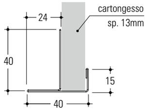
Profilo di raccordo "PR.PPF" per veletta verticale e controsoffitto, idoneo per montaggio con sistema tipo Vert Flat. Nella rappresentazione adiacente viene mostrata l'applicazione del profilo "PR.PPF" su un pannello in cartongesso (da 13mm di spessore) ed il pannello Vert Flat in appoggio.
