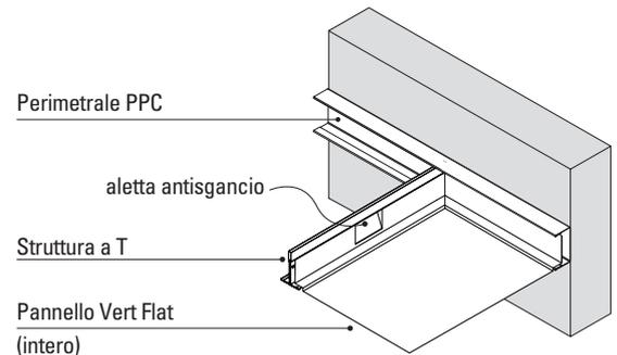
Il **PDL** oltre a svolgere la funzione di profilo perimetrale, ha come caratteristica la possibilità di creare scuretti data la sua forma scalettata e grazie a quest'ultima inoltre è possibile posizionare il profilo T sulla parte superiore o inferiore di esso. La colorazione del profilo PDL può variare a seconda della struttura T oppure dei pannelli scelti che saranno montati sul controsoffitto.
