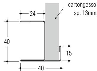
Profilo di raccordo "PR.PPH" per veletta verticale e controsoffitto, idoneo per montaggio con sistema tipo Vert Flat. Il profilo consente una perfetta integrazione con pannello tagliato o intero. Nella rappresentazione adiacente viene mostrata l'applicazione del profilo "PR.PPH" su un pannello in cartongesso (da 13mm di spessore) ed il pannello Vert Flat in appoggio. In caso di pannello tagliato viene aggiunto un profilo a "C" di bloccaggio per garantire la complanarità.
