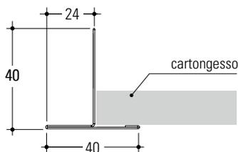
Profilo di raccordo "PR.PPT" per compenso orizzontale e controsoffitto, idoneo per montaggio con sistema tipo Vert Flat. Nella rappresentazione adiacente viene mostrata l'applicazione del profilo "PR.PPT" ed il pannello Vert Flat in appoggio.
