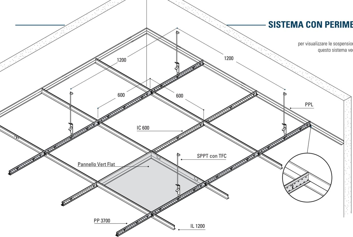
Il **PPL** è un classico perimetrale a L idoneo per l'applicazione con pannelli tipo Vert Flat. La colorazione del profilo PPL può variare a seconda della struttura T oppure dei pannelli scelti che saranno montati sul controsoffitto.
