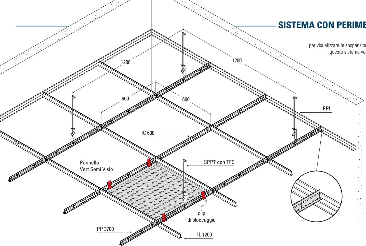
Il **PPL** è un classico perimetrale a L idoneo per l'applicazione con pannelli tipo Vert Semi Visio. La colorazione del profilo PPL può variare a seconda della struttura T oppure dei pannelli scelti che saranno montati sul controsoffitto.
