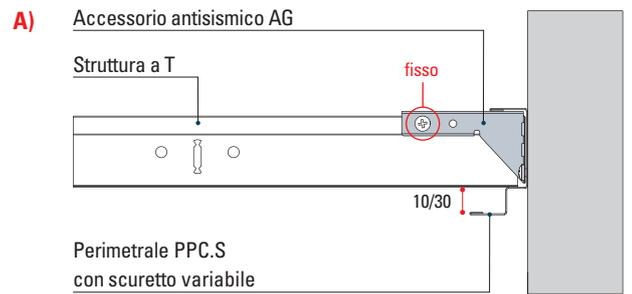
L'**accessorio antisismico** ha la possibilità una volta montato sul profilo di regolare l'angolazione per adattarsi ad ogni tipo di necessità.
