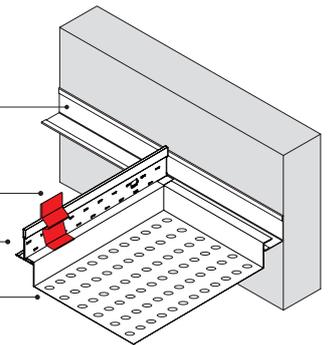
Il **PPC** oltre a svolgere la funzione di profilo perimetrale, ha come caratteristica la possibilità di rendere compianare un pannello metallico tagliato, utilizzando all'interno un profilo a C favorendone la rigidità e il bloccaggio dello stesso. La colorazione del profilo PPC può variare a seconda della struttura T oppure dei pannelli scelti che saranno montati sul controsoffitto.
