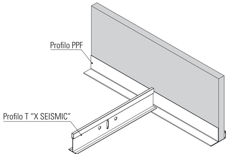
Il **PPF** oltre a svolgere la funzione di profilo perimetrale, ha come caratteristica quella di fungere da profilo di raccordo per i salti di quota (es. velette) evitando così processi di stuccatura ulteriori. E' possibile l'inserimento di pannelli in cartongesso da 13 e 15 mm. La colorazione del profilo PPF può variare a seconda della struttura T oppure dei pannelli scelti che saranno montati sul controsoffitto.
