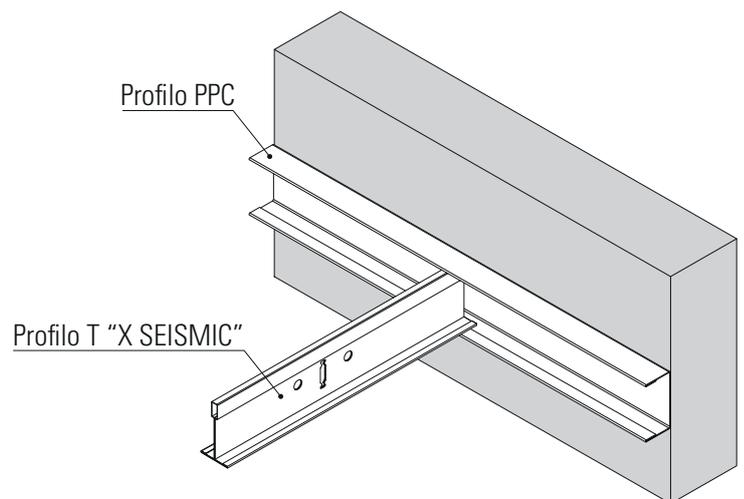
Il **PPC** oltre a svolgere la funzione di profilo perimetrale, ha come caratteristica la possibilità di rendere complanare un pannello metallico tagliato, utilizzando all'interno un profilo a C favorendone la rigidità e il bloccaggio dello stesso. La colorazione del profilo PPC può variare a seconda della struttura T oppure dei pannelli scelti che saranno montati sul controsoffitto.
