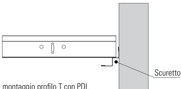
montaggio profilo T con PDL
