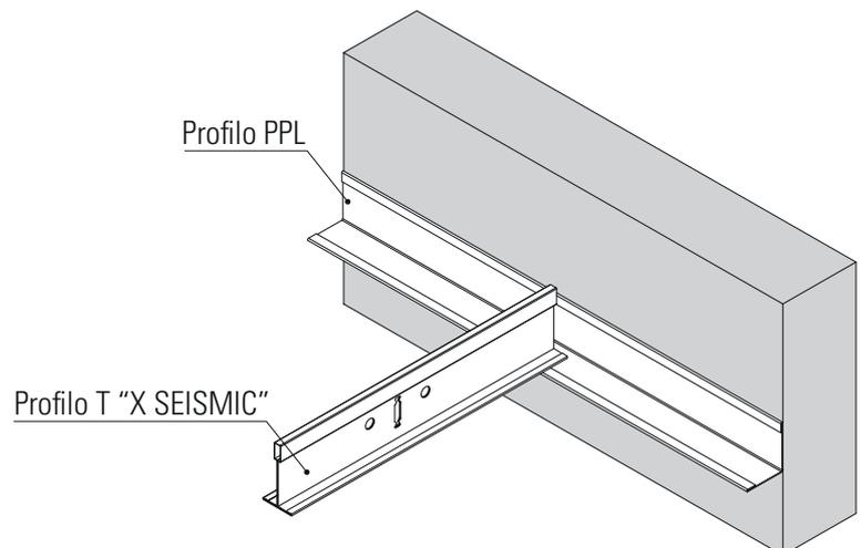
Il **PPL** è un classico profilo perimetrale a L con base a vista di 24mm. La colorazione del profilo PPL può variare a seconda della struttura T oppure dei pannelli scelti che saranno montati sul controsoffitto.
