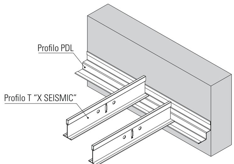
Il **PDL** oltre a svolgere la funzione di profilo perimetrale, ha come caratteristica la possibilità di creare scuretti data la sua forma scalettata e grazie a quest'ultima inoltre è possibile posizionare il profilo T sulla parte superiore o inferiore di esso. La colorazione del profilo PDL può variare a seconda della struttura T oppure dei pannelli scelti che saranno montati sul controsoffitto.
